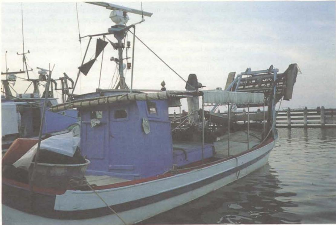
Foto 1: Imbarcazione attrezzata con draga idraulica.
